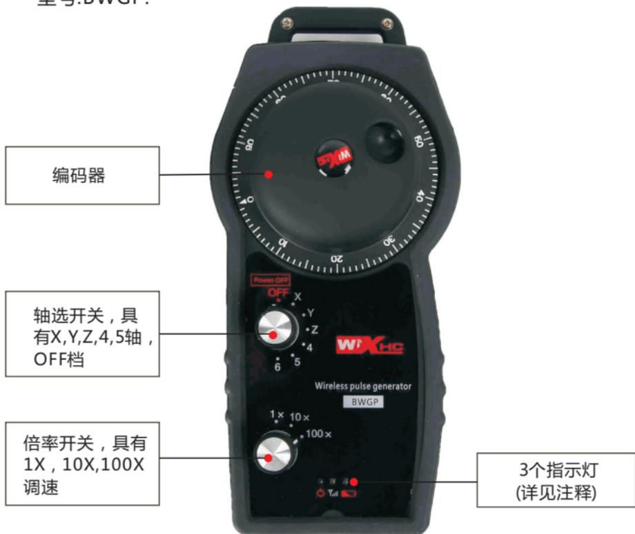
注释：电源指示灯(左一):当轴选开关切换到OFF档，电源关闭,电源指示灯熄灭;当轴选开关打到X,Y,Z,4,5档位时，电源接通，电源指示灯常亮.
