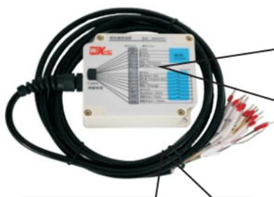
为了保证距离远，需要将接收器安装在机箱顶部，外露，不要装在机箱内
