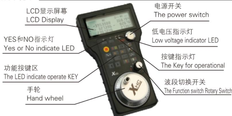
备注：当低压指示灯亮的时候，表示电池电量快用完了，建议更换电池。
